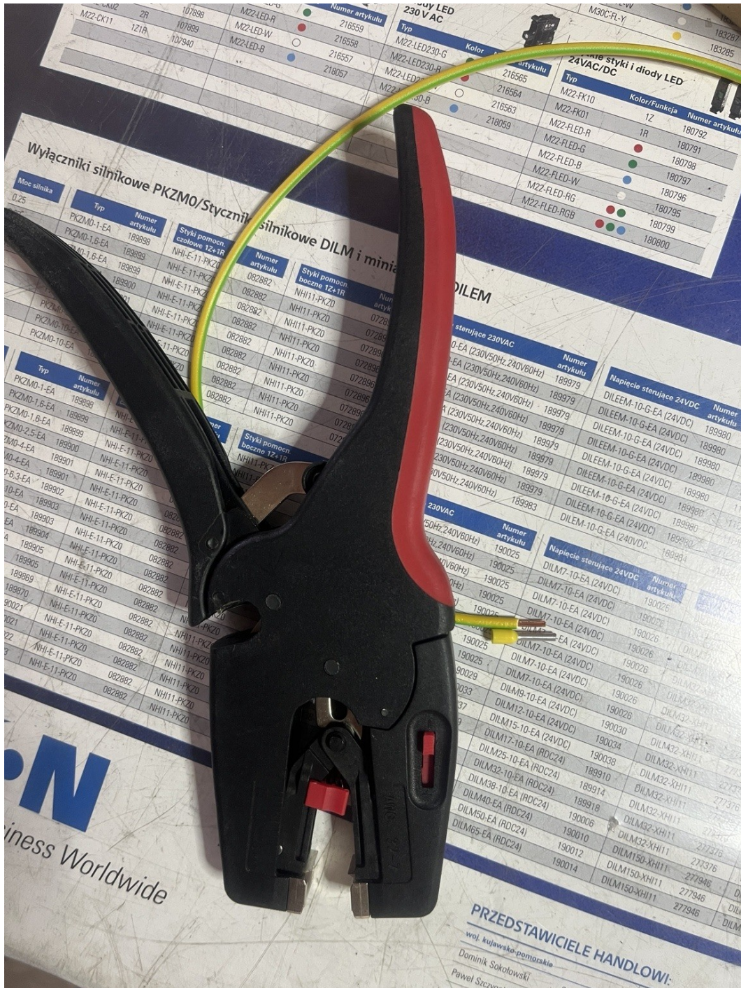
Przykład zbyt krótkiego odizolowania: żyła nie wypełnia metalowej części tulejki na pełną długość.
